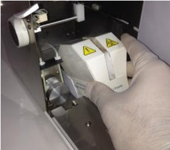
Fig. 16 Colocando el limpiador 1
