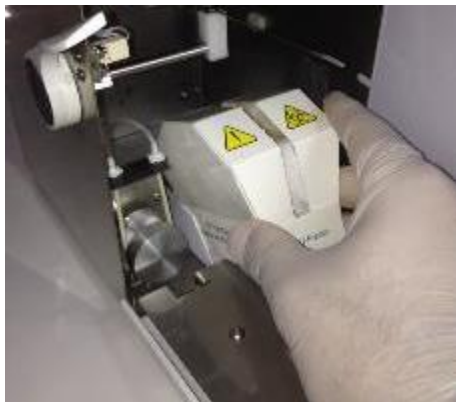
Fig. 16 Colocando el limpiador 1
