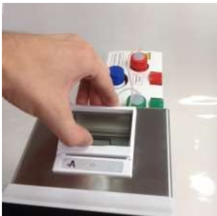
Fig. 36 Apertura del porta rollo
