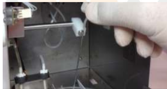
Fig. 41 Conexión tubería pinch
