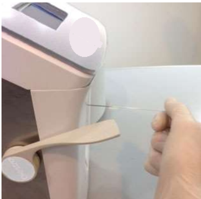
Fig. 23 Cargado desde un capilar
