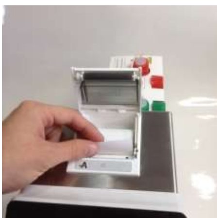
Fig. 37 Cambio del rollo de papel
